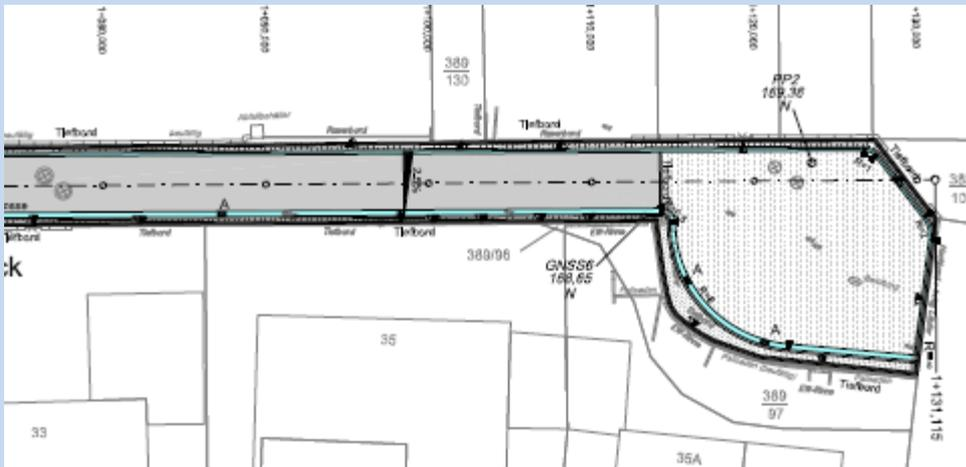
Verschiebung des Überganges zw. Asphalt und Pflaster zum Wendehammer möglich
